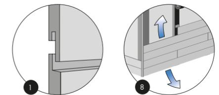
Il sistema prevede un'intercapedine in corrispondenza della parete portante, determinando la creazione di un flusso d'aria che impedisce l'accumulo di calore o di umidità.
